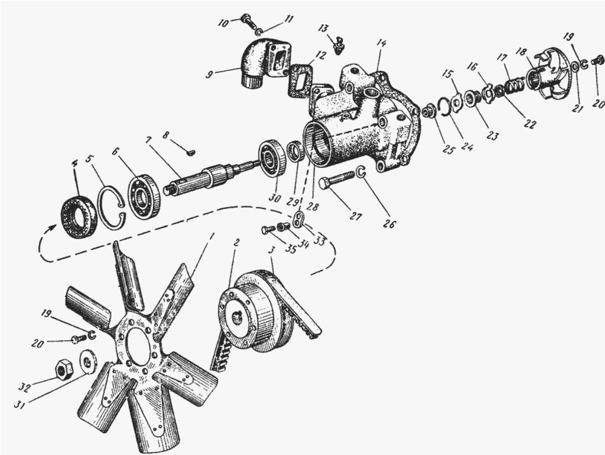
Рис. 8. Водяной насос и вентилятор
