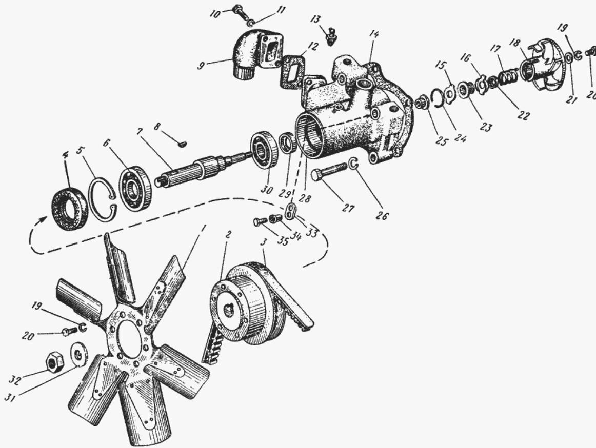
Рис. 8. Водяной насос и вентилятор
